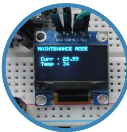
Proses penyetelan batas suhu dilakukan secara langsung dengan menggunakan tombol selektor. Sedangkan untuk menaikkan atau menurunkan variabel batas dilakukan dengan menggunakan touch sensor di GPIO 12 dan 14.
